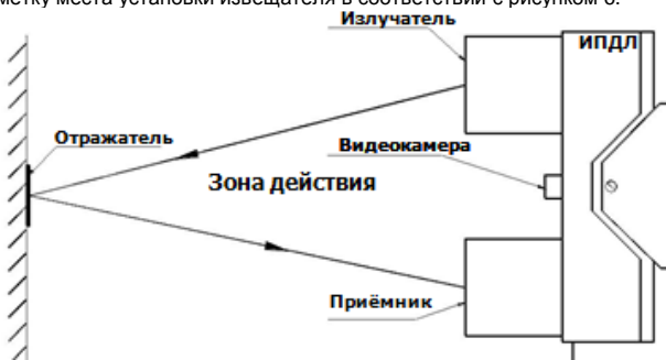
Рис. 6 Схема взаимного расположения извещателя и отражателя
